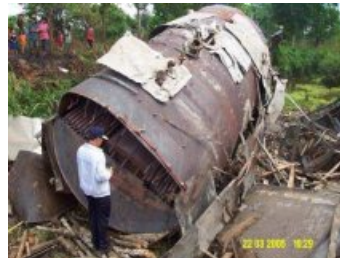
สภาพการฉีกขาดของเหล็กยึดโยงและการแตก ระเบิดของผนังหลัง
